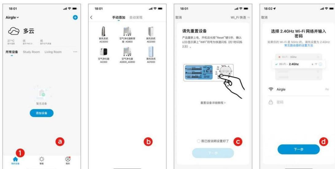
d. 设备将需要 1-3 分钟进行搜索，待设备成功连接到 Wi-Fi 网络之后，您的设备便可以开始正常使用。如果您的设备在 **Wi-Fi 快连** 模式下无法成功连接到 Wi-Fi 网络，您可以通过切换**兼容模式**进行配网链接。
